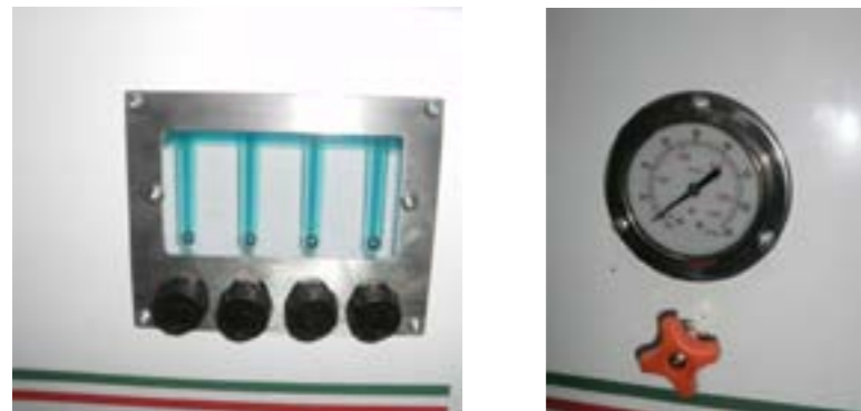
Sistemi di controllo con flussometri integrati e manometro
