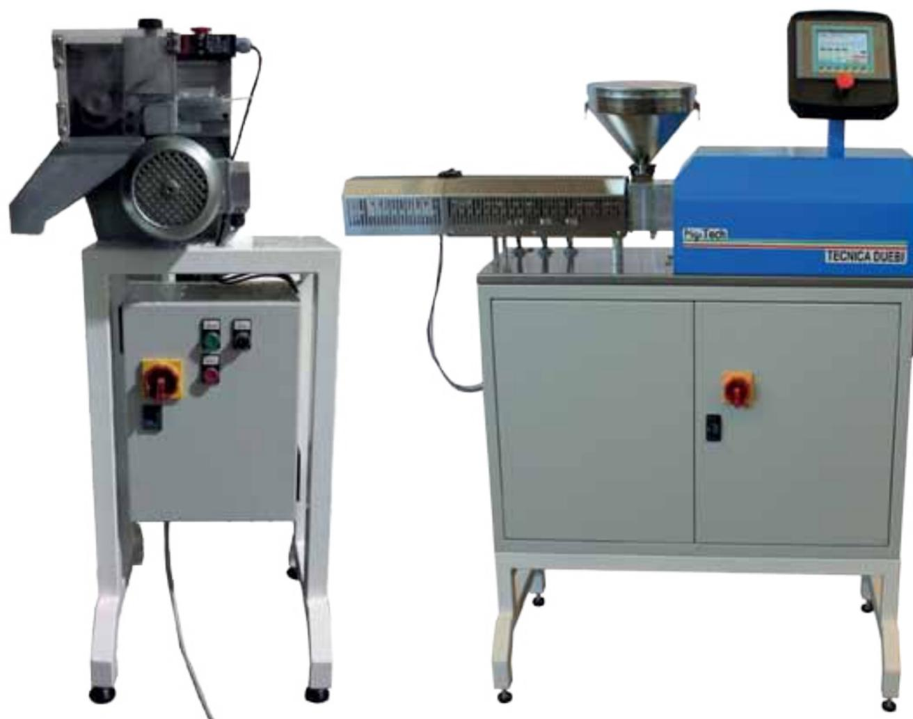
**Ottimizzate** per lavorare in sequenza e riprodurre granuli delle dimensioni volute da scarti di qualsiasi materiale plastico.
